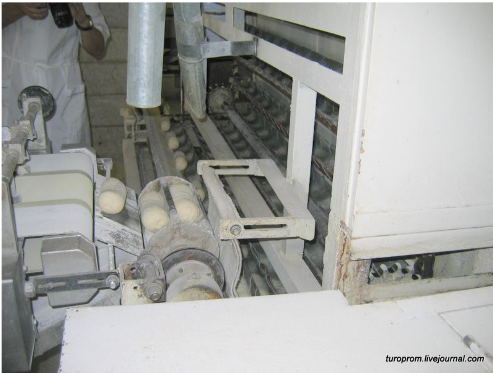
Специальное устройство – разрезает тесто на аккуратные шарики.
